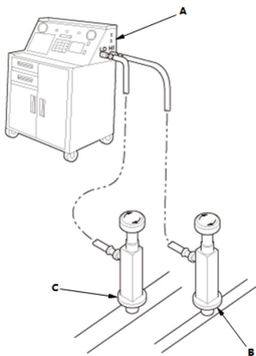
如图所示，遵循设备制造商的说明，将一个 R-134a 制冷剂回收/循环/加液站 (A) 连接到高压检修口 (B) 和低压检修口 (C) 上。
